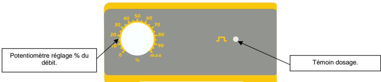
La pompe dose manuellement le pourcentage sélectionné avec le potentiomètre.
