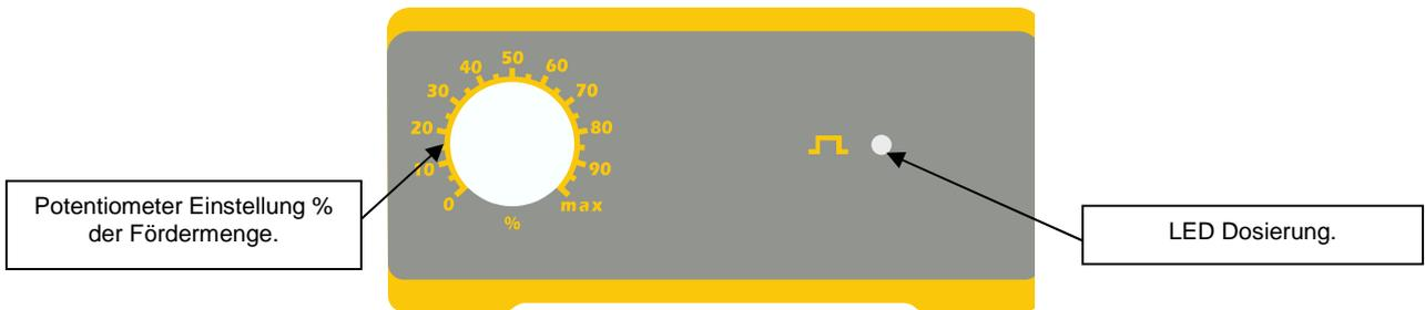
Die Pumpe dosiert manuell den mit dem Potentiometer gewählten Prozentsatz
