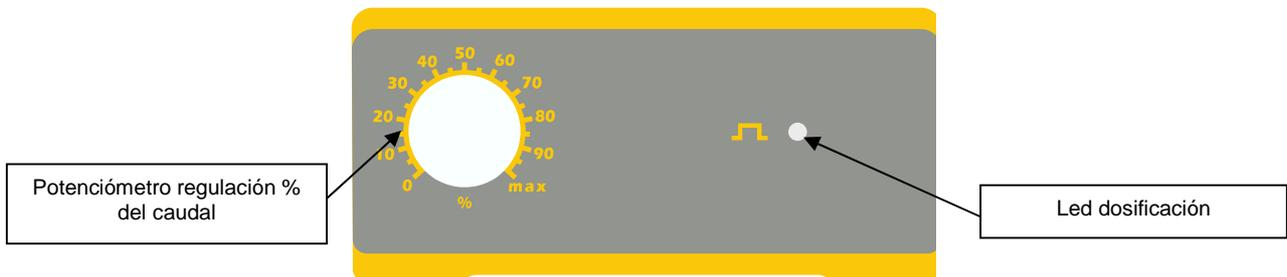
La bomba dosifica el porcentaje seleccionado de forma manual con el potenciómetro.
