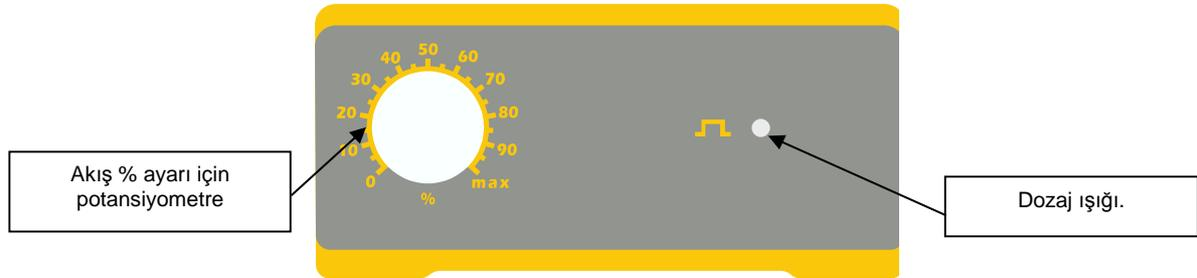
Pompa potansiyometre ile seçilen yüzde değerinde manüel olarak dozajlama yapar.
