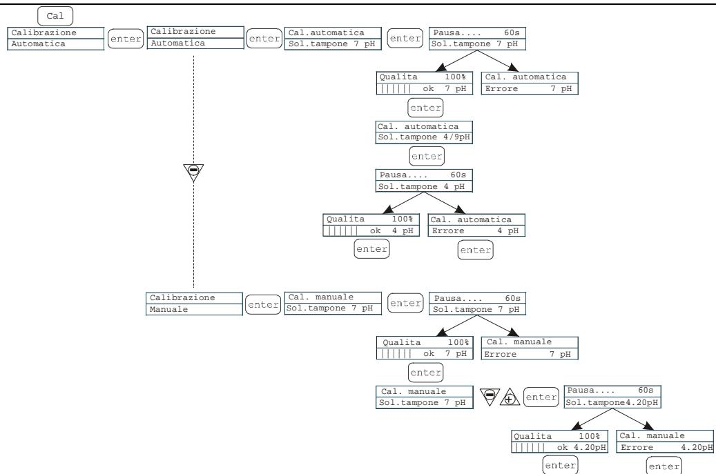
È possibile scegliere la modalità automatica o manuale, in entrambi i casi la calibrazione a pH 7 avviene in automatico.
