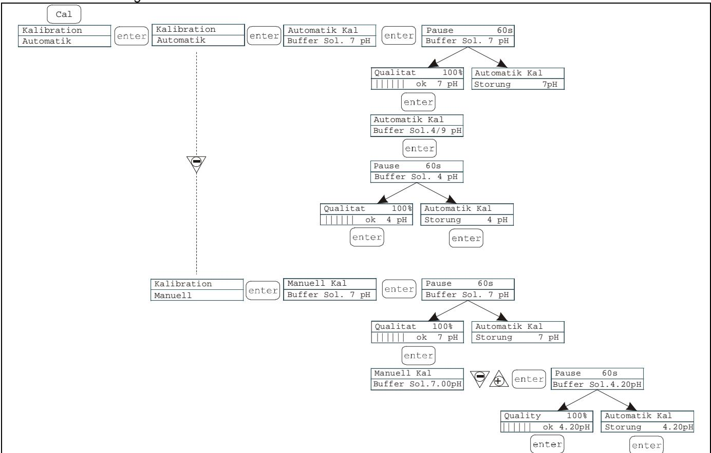
Es ist möglich, die automatische oder die manuelle Kalibrierung zu wählen. In beiden Fällen erfolgt die Kalibrierung auf den pH-Wert 7 automatisch.
